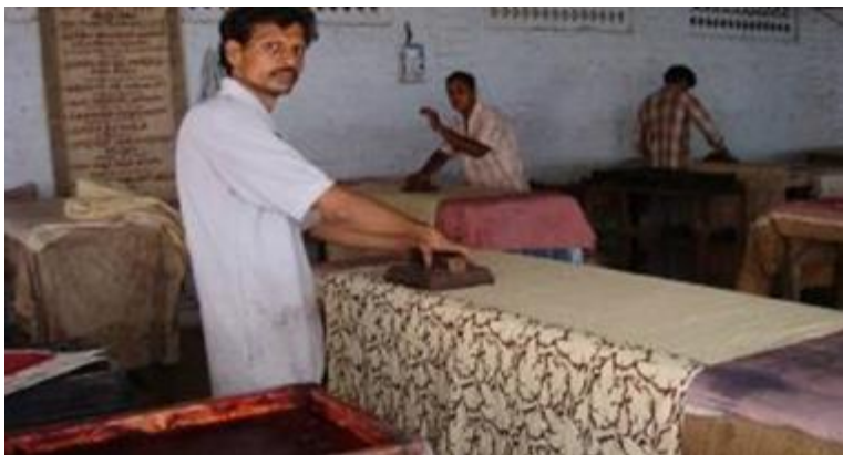
Prima stampa con i blocchi di legno con colori naturali.
