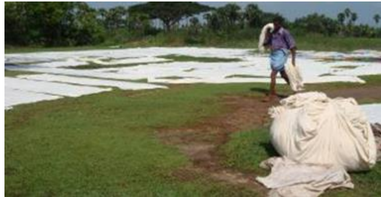
La tela grezza passa al candeggiamento naturale con sterco di vacca e acqua in modo da rimuovere l'amido e preparare il tessuto per la stampa.
