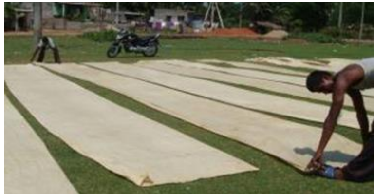
Il tessuto tinto con Myrobalam viene essiccato sul campo all'aria aperta.
