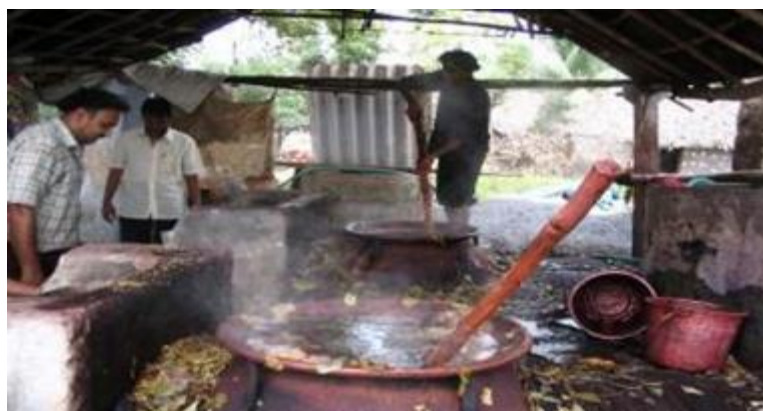
Bollitura del tessuto con foglie di Jagi e Algrin, per rimuovere la polvere e fissare il colore.
