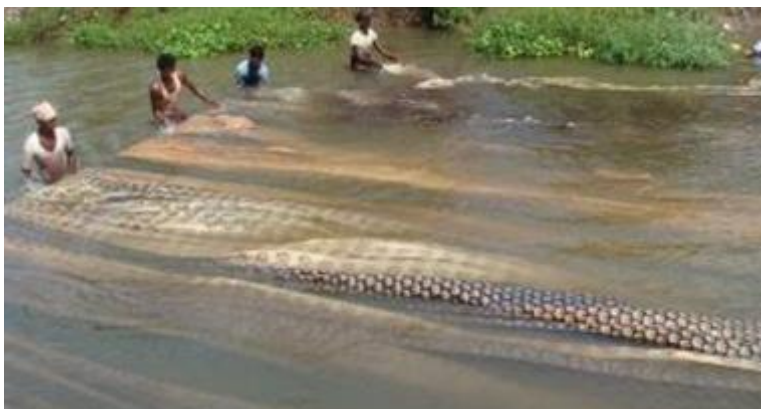
Dopo la prima stampa, il tessuto viene lavato una seconda volta.
