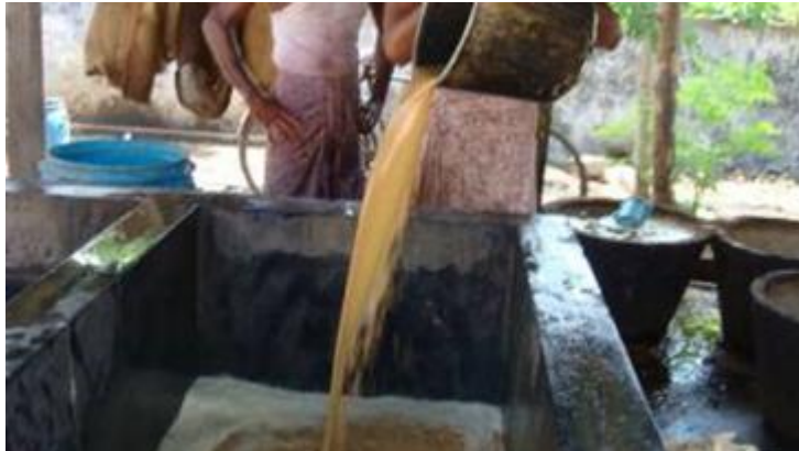
Preparazione del tessuto con il Myrobalam - colore di base.
