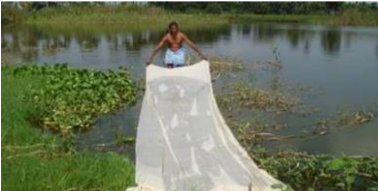
La tela grezza passa al candeggiamento naturale con sterco di vacca e acqua in modo da rimuovere l'amido e preparare il tessuto per la stampa.
